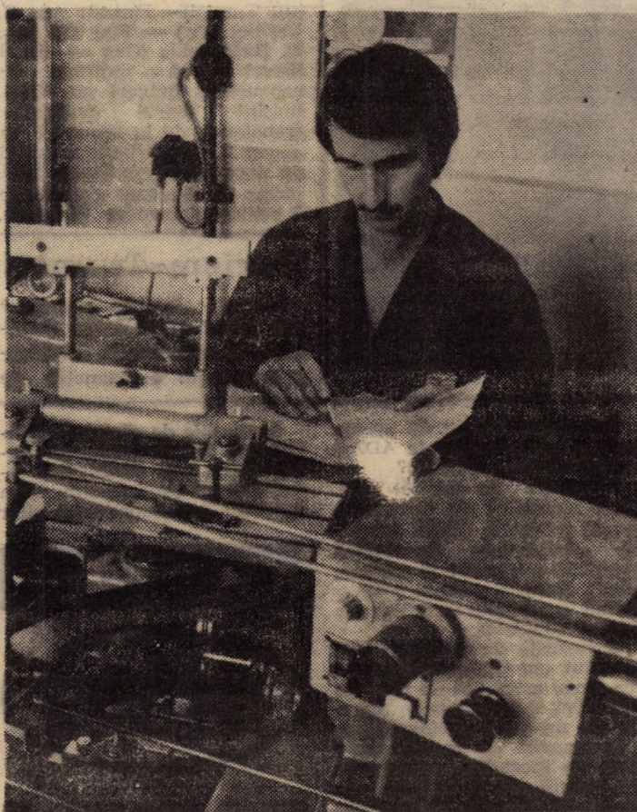
La o mașină de rectificat profile prin copiere din secția sculărie a întreprinderii „FLARO” din Sibiu, comunistul Ioan Brunete, unul din tinerii secției cu o bună pregătire profesională, realizează S.D.V.-uri cu profile complexe și ogive. Foto: Fred NUSS
